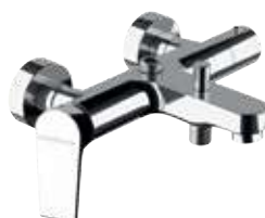
260/AT 34 Miscelatore monocomando vasca/doccia con attacco alto da 3/4" ed attacco inferiore da 1/2". Wall mtg. bath/shower single-lever mixer with upper connection 3/4" and lower connection 1/2".
