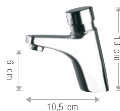
35C/TP Rubinetto temporizzato, tempo di apertura 6-8 secondi. Temporized pillar tap, opening time 6-8 seconds.
