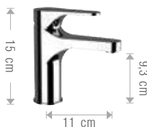
380/SF Miscelatore monocomando lavabo senza scarico e senza foro nel corpo. Single-lever basin mixer without waste and without body hole.
